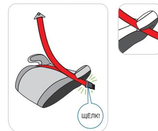
И кресло и ребенок фиксируются штатным инерционным ремнем безопасности, а высота кресла подобрана так, чтобы ремень проходил ниже уровня шеи ребенка. Это обеспечивает необходимый уровень безопасности и облегчает снятие и установку кресла в автомобиль.
