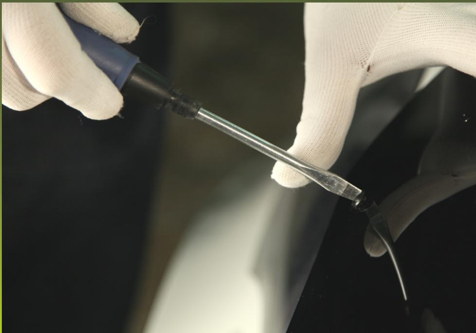
Закрутите винты на дефлекторе, где есть металлические крепления, а в центре плавно нажмите на дефлектор на месте застёжек для закрепления.
