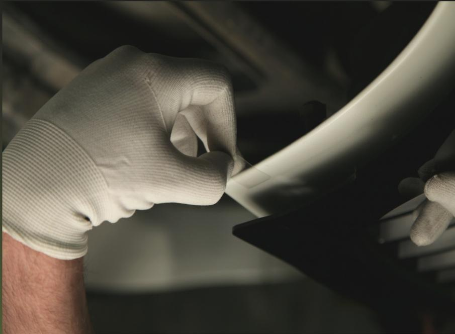
Спиртовой салфеткой обезжирьте определенные заранее места креплений дефлектора. Заклейте очищенные места клейкой лентой из комплекта, начиная с наружной поверхности и переходя на внутреннюю. Тем самым, Вы защитите лакокрасочную поверхность капота в местах крепления.
