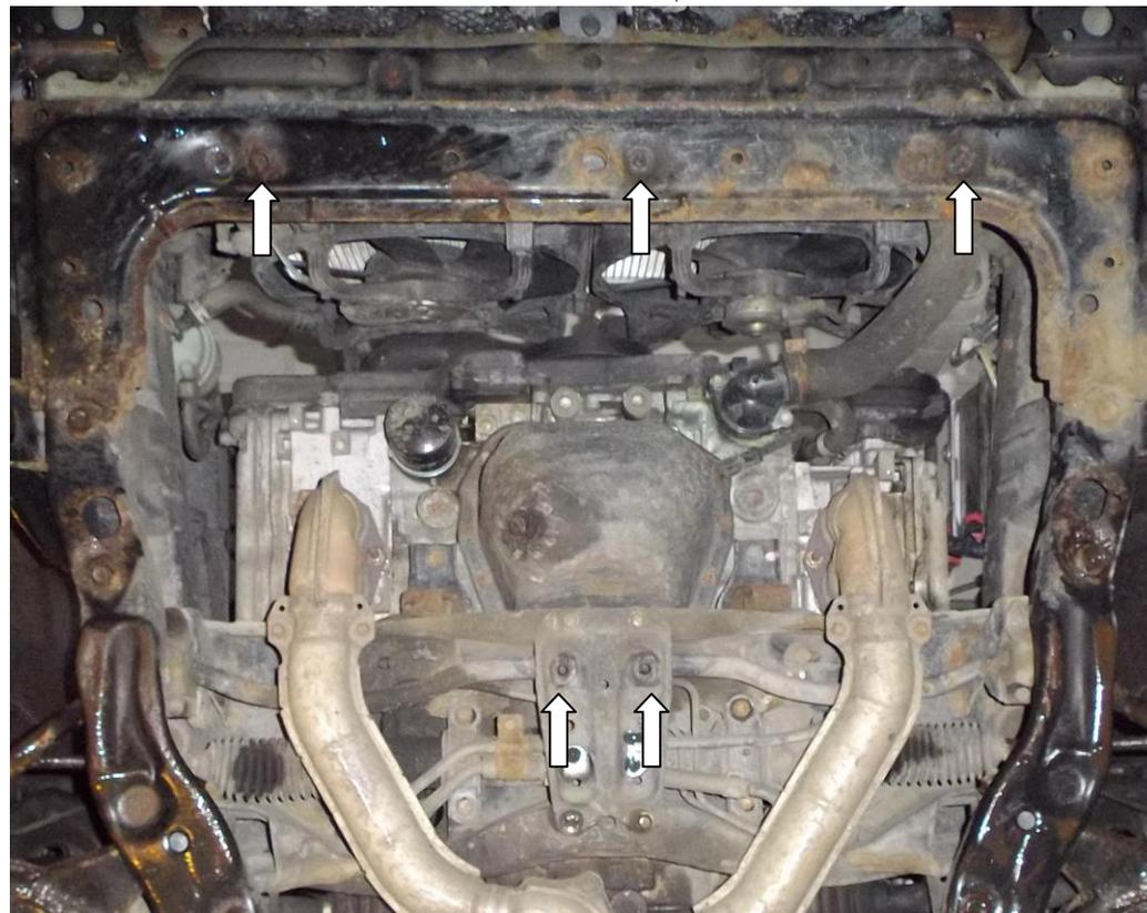
1. Снять штатный пыльник.
