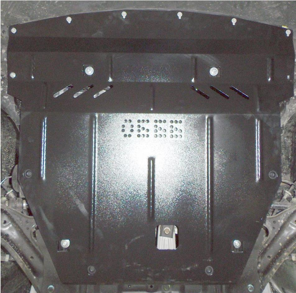
**ВНИМАНИЕ!!!** После монтажа защиты не допускается соприкосновение элементов защиты с движущимися элементами узлов и агрегатов автомобиля.
