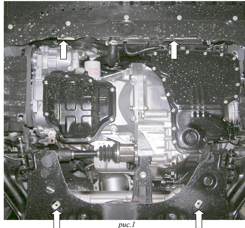
1. Завести планки 8 в задние отверстия подрамника двигателя, наложить планки 9 над отверстиями подрамника радиатора (рис.1).
