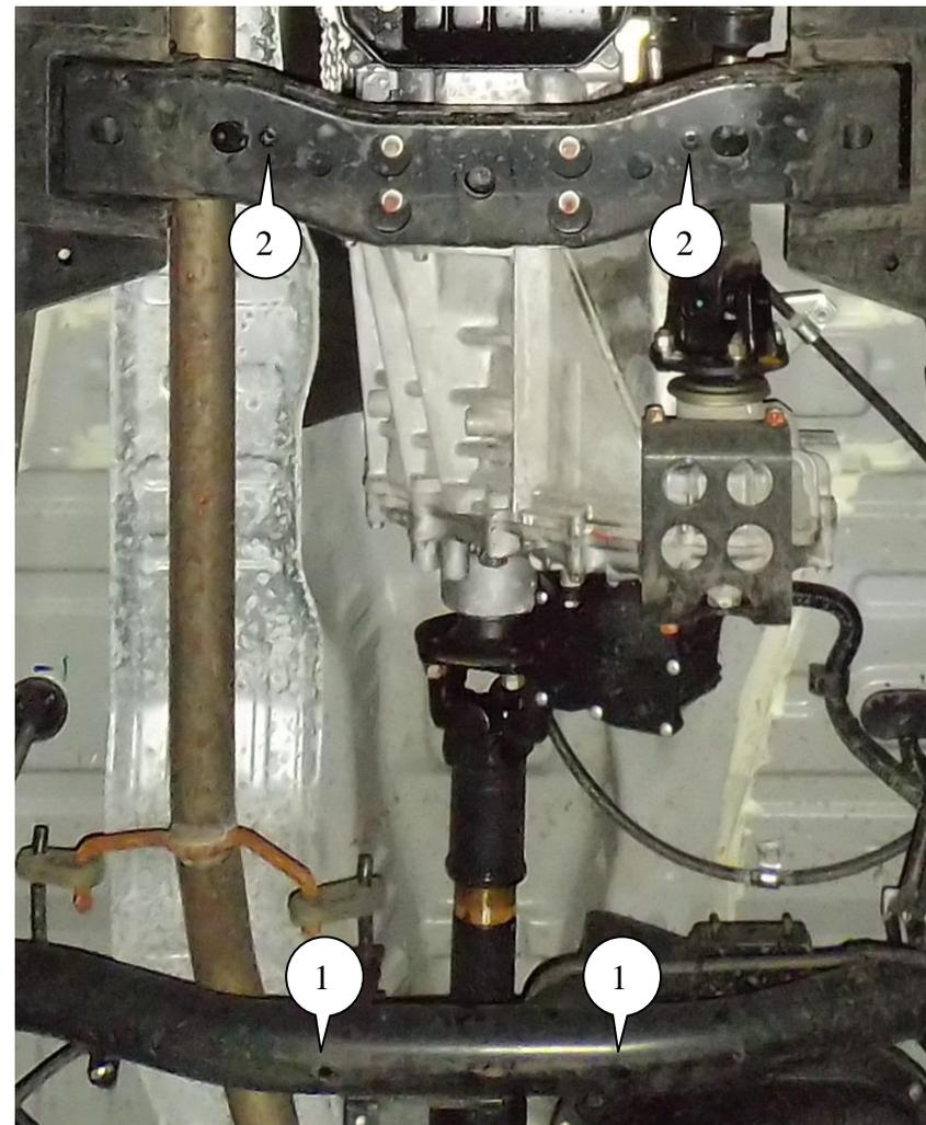
1. Рассверлить 2 штатных отверстия до  $\phi 13$  в местах поз.1, рис.1.
