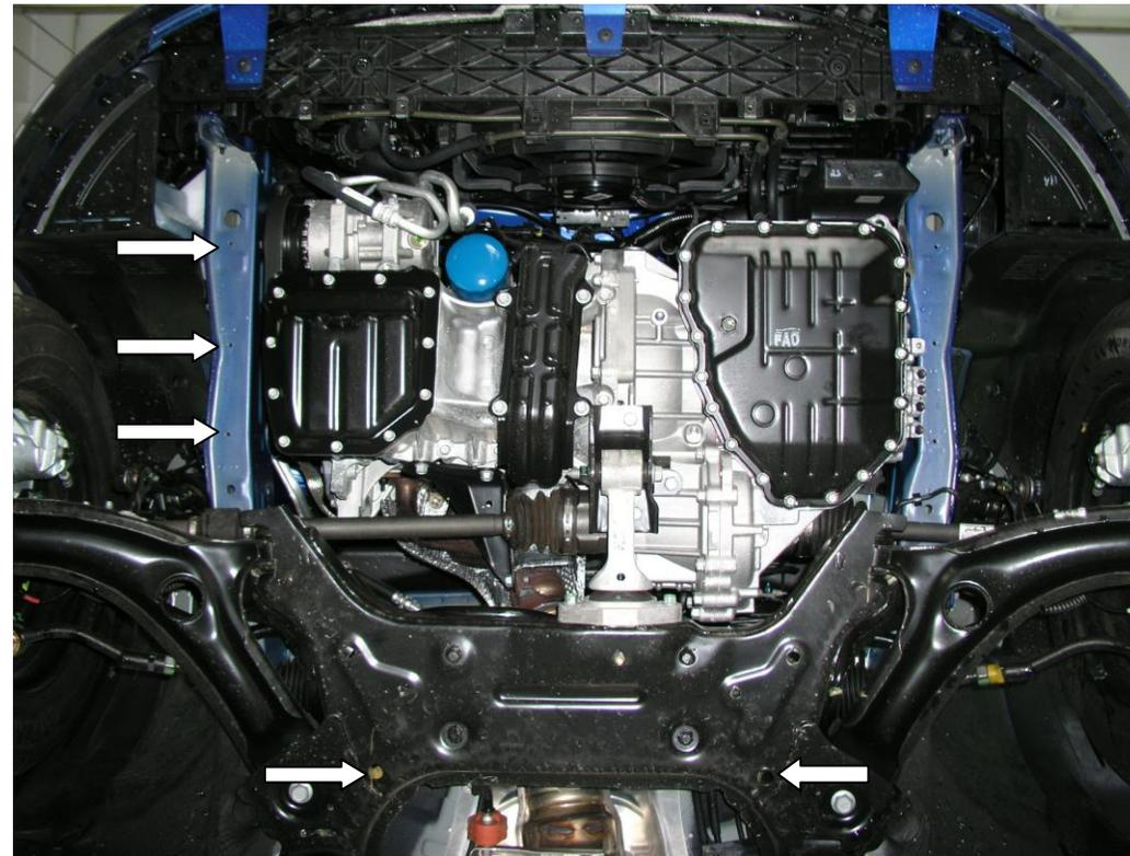
1. Снять два боковых штатных пыльника.
