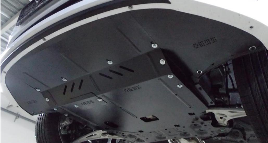
**ВНИМАНИЕ!!!** После монтажа защиты не допускается соприкосновение элементов защиты с движущимися элементами узлов и агрегатов автомобиля.
