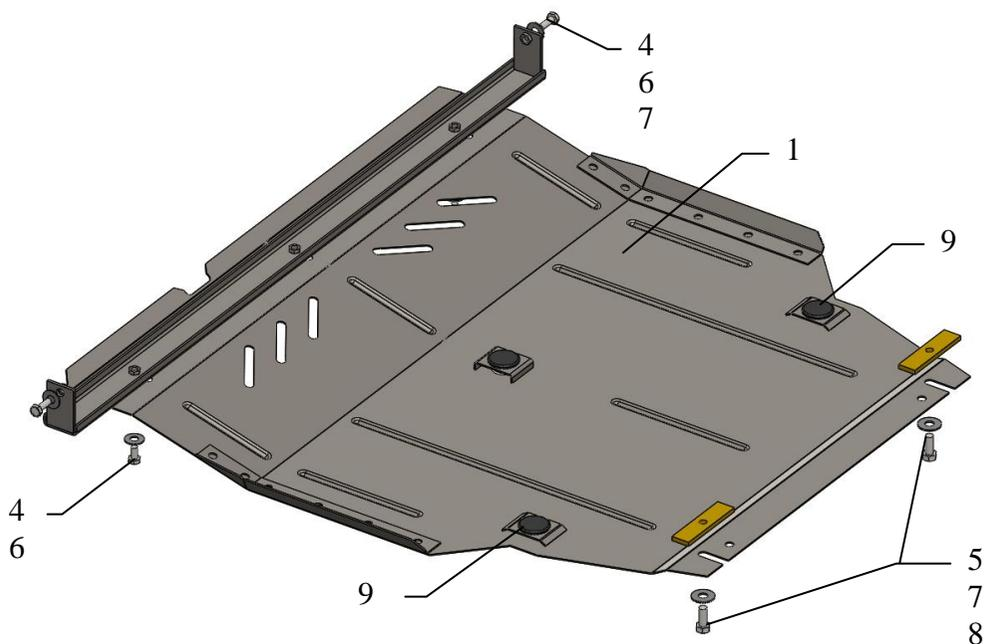
**ВНИМАНИЕ!!!** После монтажа защиты не допускается соприкосновение элементов защиты с движущимися элементами узлов и агрегатов автомобиля.
