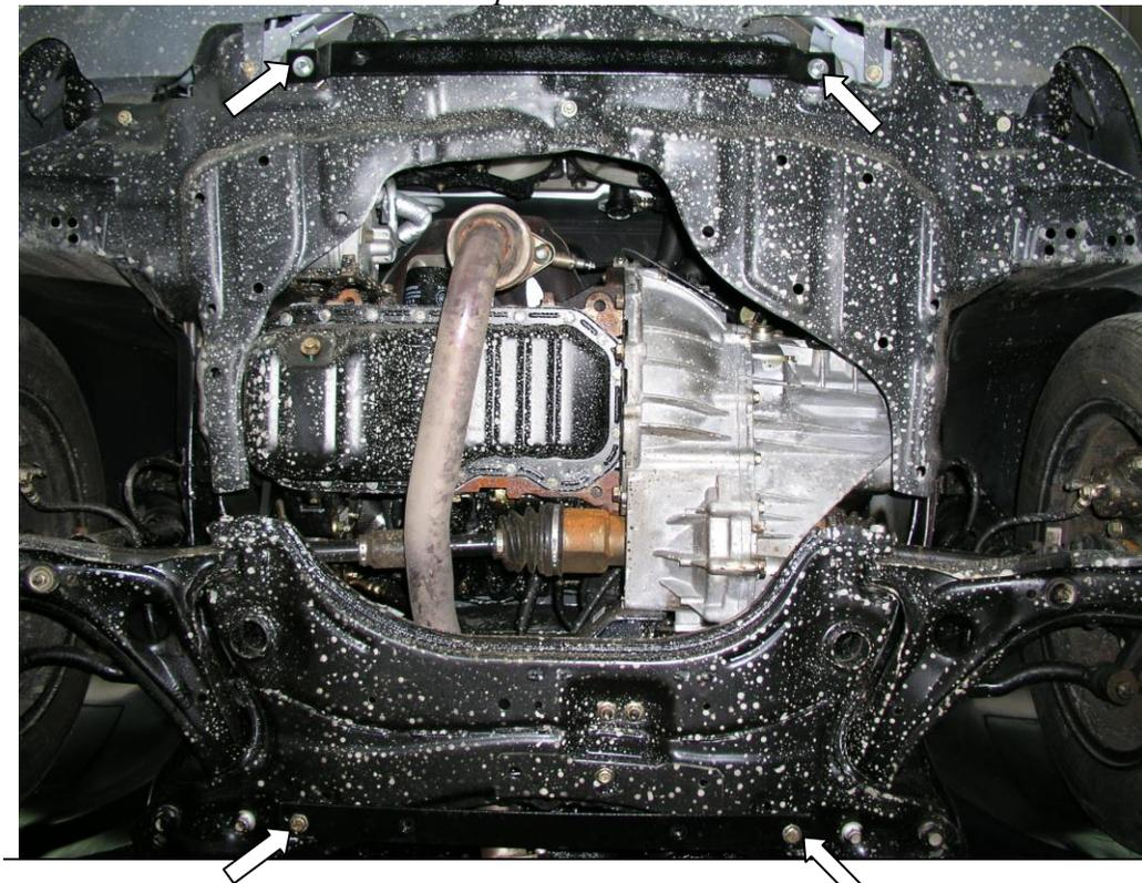
1. Открутить четыре передних штатных болта крепления пыльника и отвернуть пыльник, рис.1.
